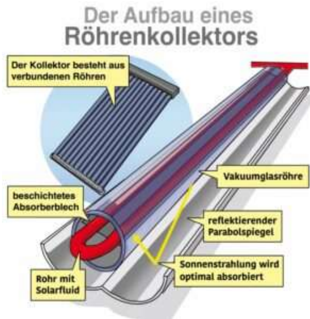
Abbildung 28: Aufbau eines Röhrenkollektors
